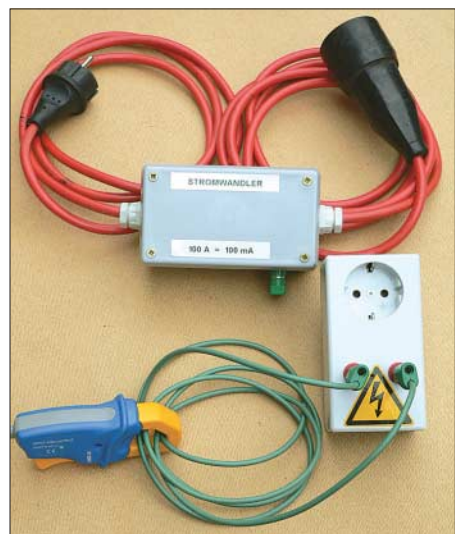
Bild 14: Oben Ansicht eines Wandlers 100 A / 0,1 A mit sehr guten Abbildeigenschaften; die Bürdenspannung ist an den beiden Polklemmen entnehmbar. Unten wurde der Zangenadapter Peaktech 4200 an einem Steckergehäuse-Adapter angeschaltet.
