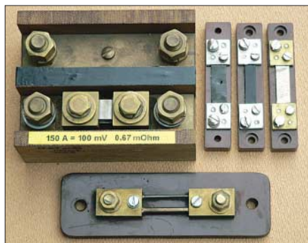
Bild 3: Nebenschlusswiderstände für unterschiedliche Nennströme
