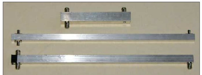
Bild 8: Oben 70-cm-Zweifachverteiler, darunter Zweifachverteiler für 2 m, Mitte mit BNC sowie unten mit N-Buchsen Fotos und Screenshot: DK7ZB
