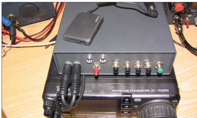
Bild 1: Ansicht des Jabra A210 mit Adapterkabel, angeschlossen über eine Interface-Box am IC-7000 bei DH8BQA
