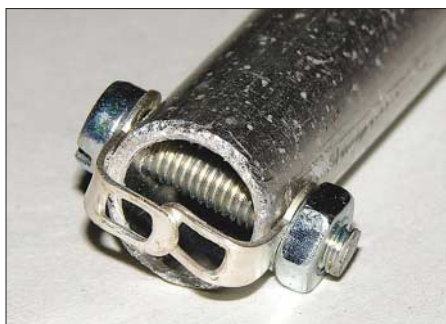
Bild 7: Konstruktion der Innenrohre mit Schrauben und Lötösen
