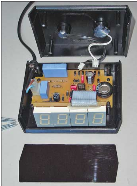
Bild 2: Ansicht des geöffneten Uhrenweckers; die Anzeigeplatine ist im Winkel zur Hauptplatine montiert.
