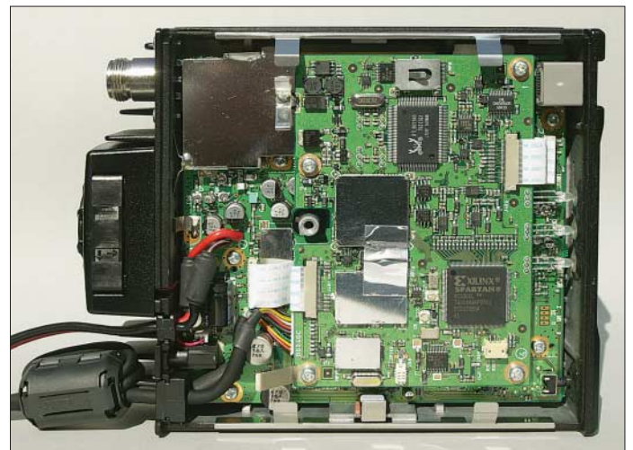
Bild 5: Sauberer Aufbau im Druckgussgehäuse – hier ein Blick auf die Digitalplatine Fotos: DG1NEJ
