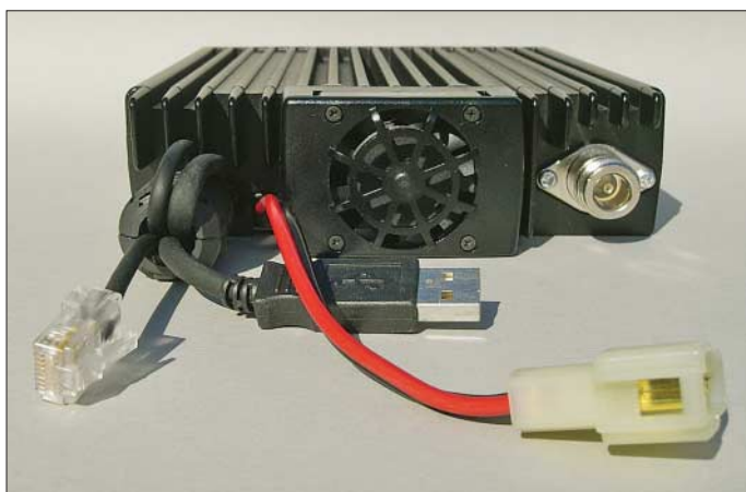
Bild 4: Bis auf Lautsprecher- und Antennenbuchse sind alle Anschlüsse über kurze Kabelstücke herausgeführt.
